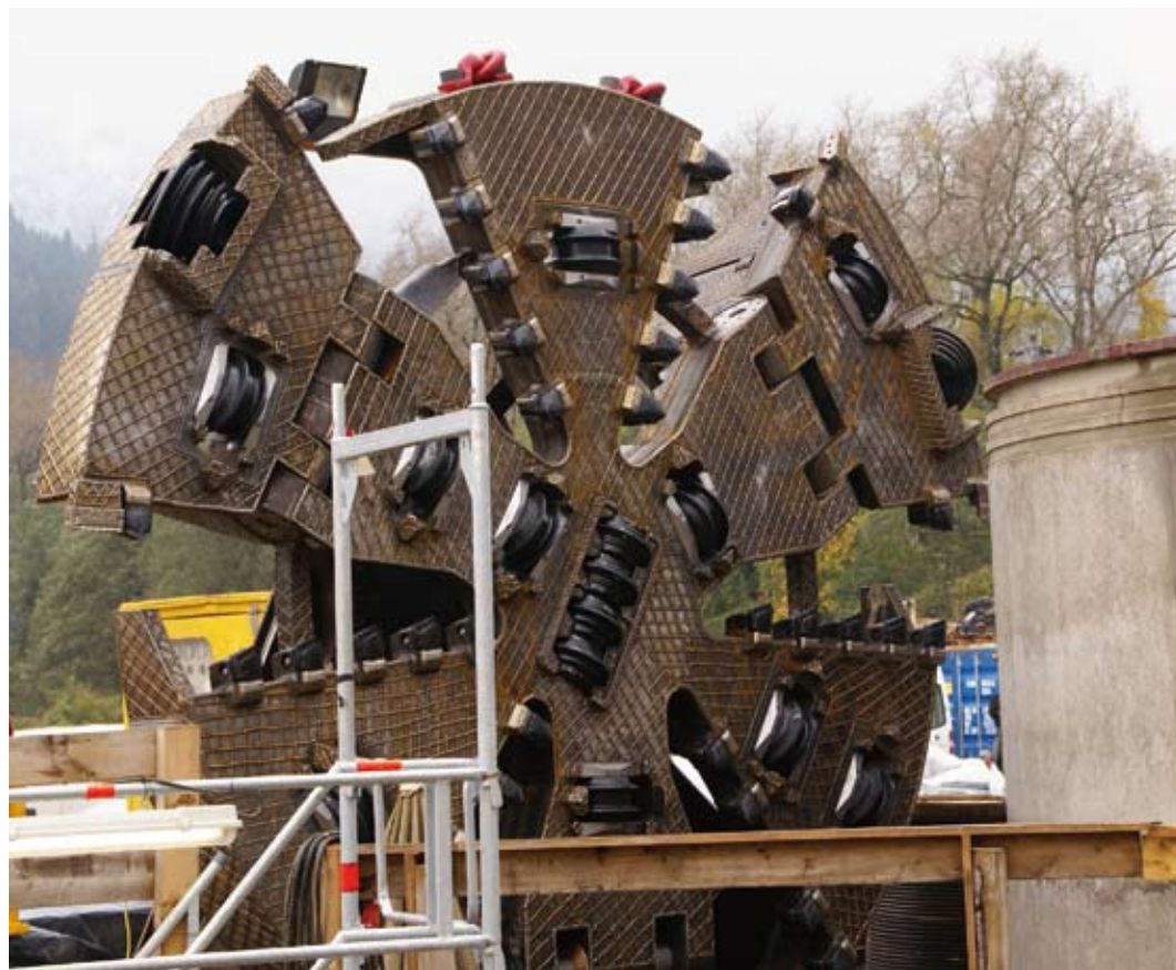
Die regelmäßige Überprüfung von Maschinen dient dem Schutz von Menschen und Geräten (im Bild: Schneidrad einer Tunnelbohrmaschine).
